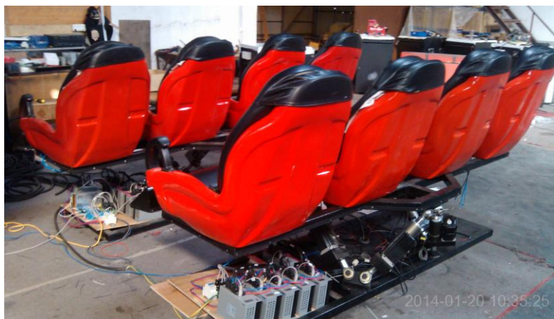
图 1-7 HS 网络化伺服驱动器及 MBOX 通讯控制板卡用于六自由度平台
