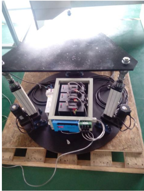
图 1-8 HS 网络化伺服驱动器及 MBOX 通讯控制板卡用于三自由度平台
